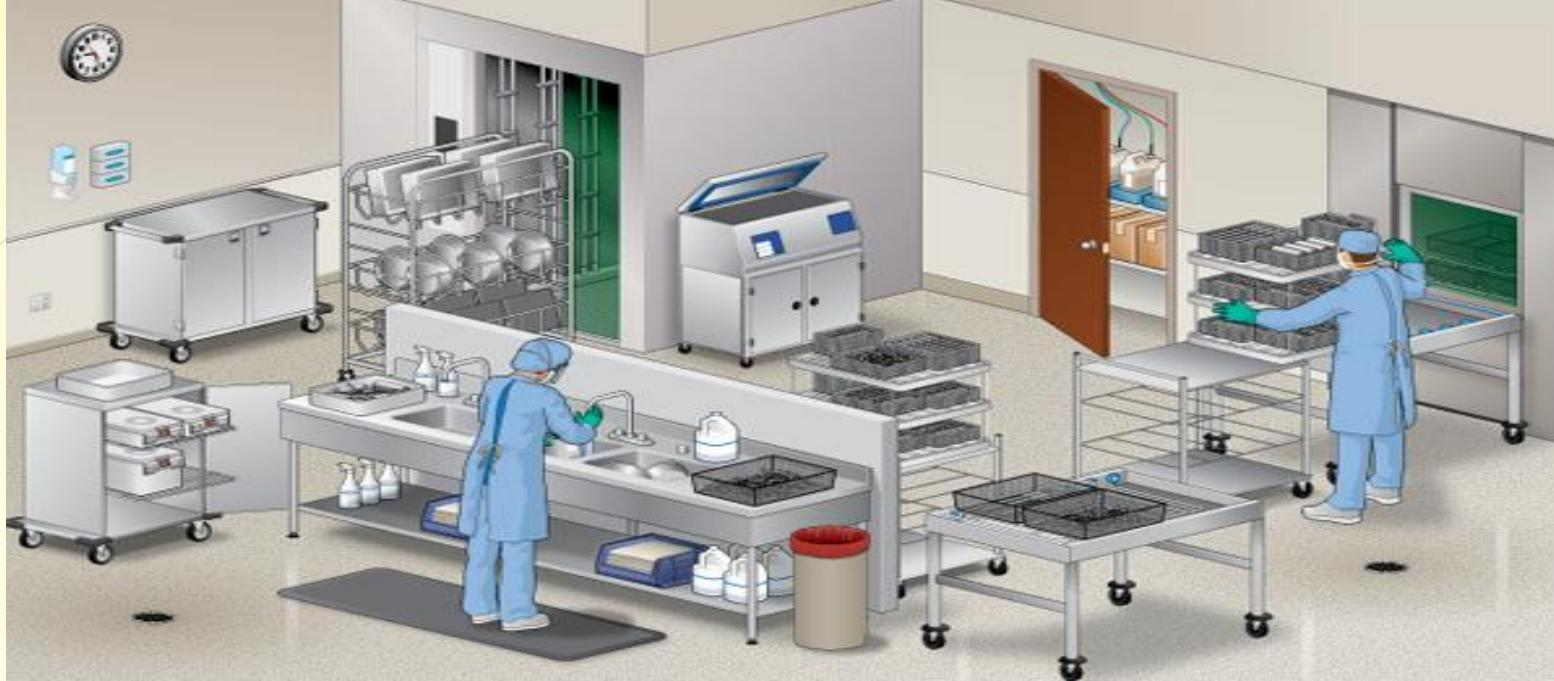
در این منطقه هیچ نوع پنکه یا تجهیزات مشابه آن نباید استفاده شود و دائم باید پنجره‌ها بسته باشند و گردش هوا توسط سیستم تهویه انجام گردد. ولی اگر این موضوع به دلیل گرمای تولید شده در اثر فعالیت ماشین‌های شستشو، وسایل اولتراسوند و آب داغ مصرفی جهت شستشوی وسایل قابل انجام نبود، حداقل پنجره‌ها باید توری فلزی جهت جلوگیری از ورود حشرات داشته باشند.
